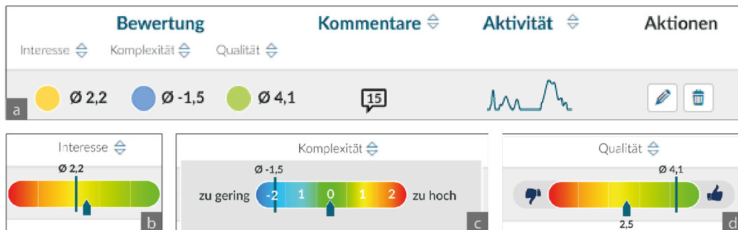
Abb. 5: Konzepte für die Bewertung und Zugriffsstatistik für Materialien (a) und verschiedene Interaktionskonzepte für die Abgabe von Bewertungen: kontinuierlicher Slider (b), diskrete Slider-Werte mit Skalenbeschriftung (c) und ikonografische Skalenbeschriftung (d).
